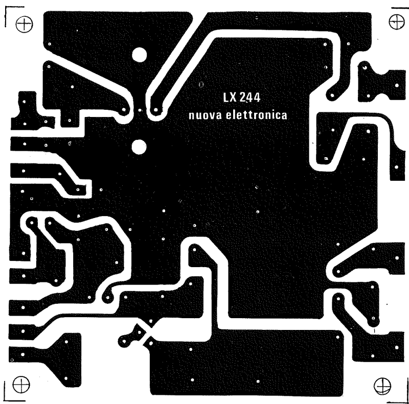
Fig. 6 Disegno a grandezza naturale del circuito stampato necessario per ricevere i componenti del doppio alimentatore da 12 a 18 volt che servirà per alimentare i telai LX.239 e LX.240.
