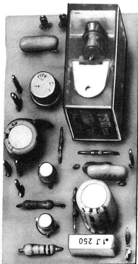
Foto di uno dei nostri prototipi impiegati per il collaudo del circuito. In questo modello mancano infatti i condensatori C5-C6 posti in parallelo ai contatti del relè.
